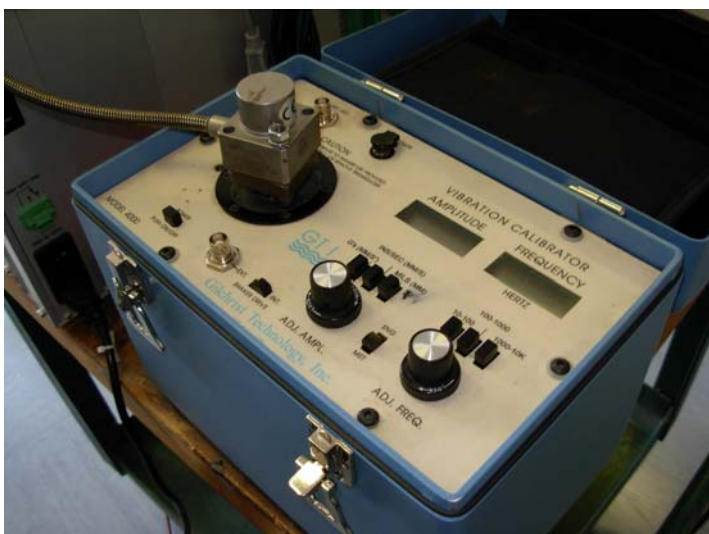
Sistema di calibrazione per sensori sismici (vibrazioni assolute)
