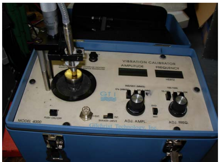
Sistema di calibrazione per sensori di prossimità (vibrazioni relative)
